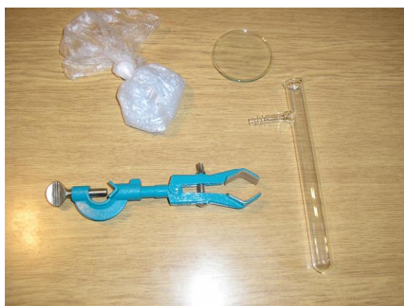
Epruvete, filter papir, stezaljke, satno staklo – pribor za ispitivanje vode
